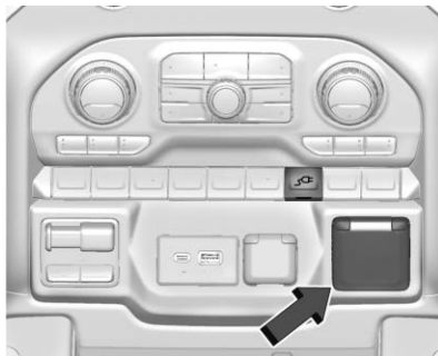
En el tomacorriente de cabina e interruptor CD/CA
